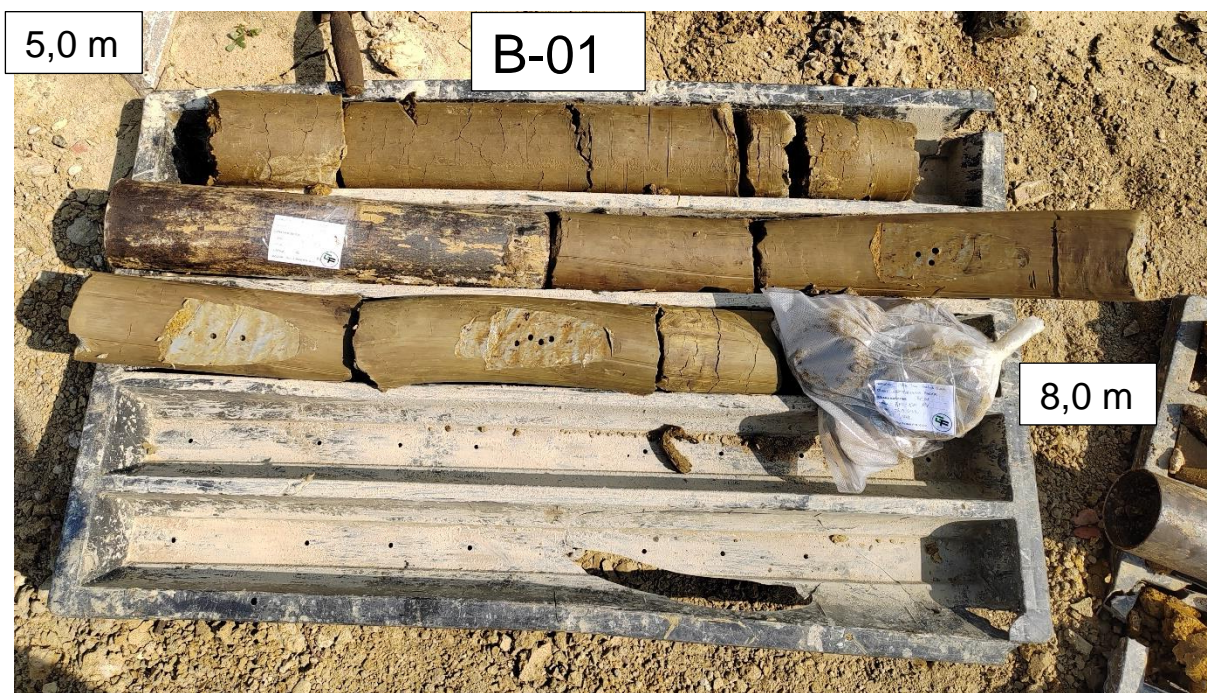
Slika 15. Bušotina B-01 – Fotografija jezgre (5,00-8,00 m)
