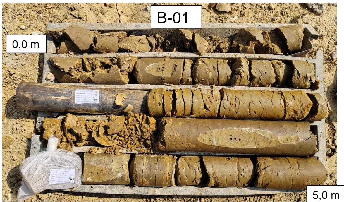
Slika 14. Bušotina B-01 – Fotografija jezgre (0,00-5,00 m)
